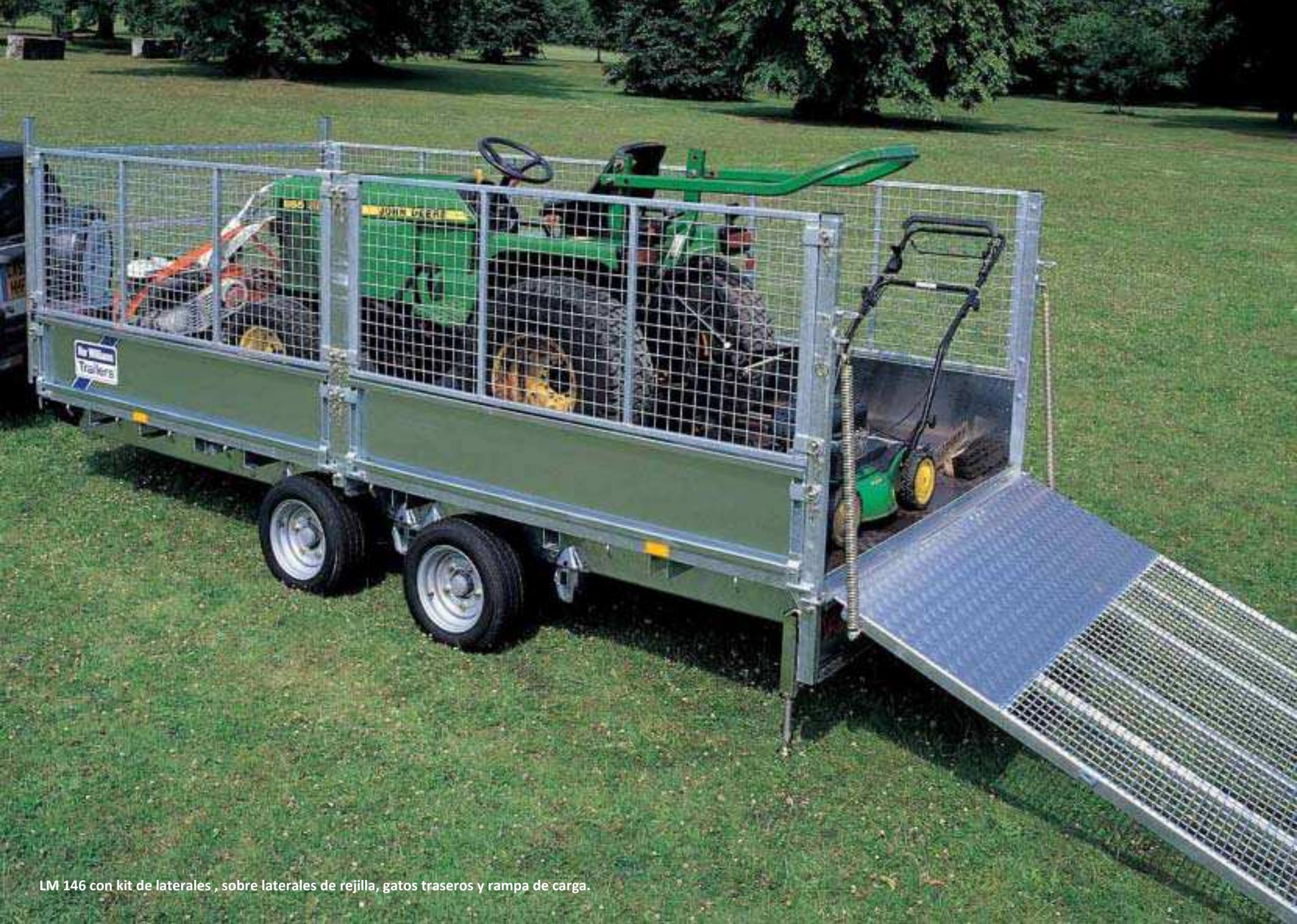
LM 146 con kit de laterales , sobre laterales de rejilla, gatos traseros y rampa de carga.
