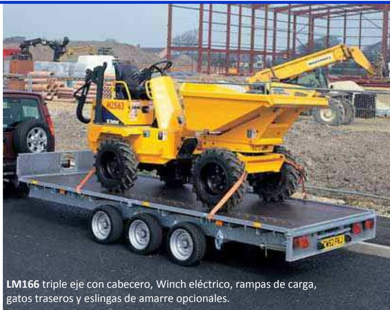
LM166 triple eje con cabecero, Winch eléctrico, rampas de carga, gatos traseros y eslingas de amarre opcionales.
